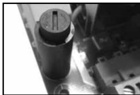
Afbeelding 6: Zekering vervangen voor CowCleaner Swing
